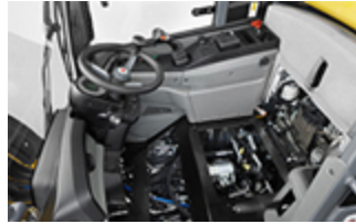
Wartungszugänge im Innenraum der Kabine
